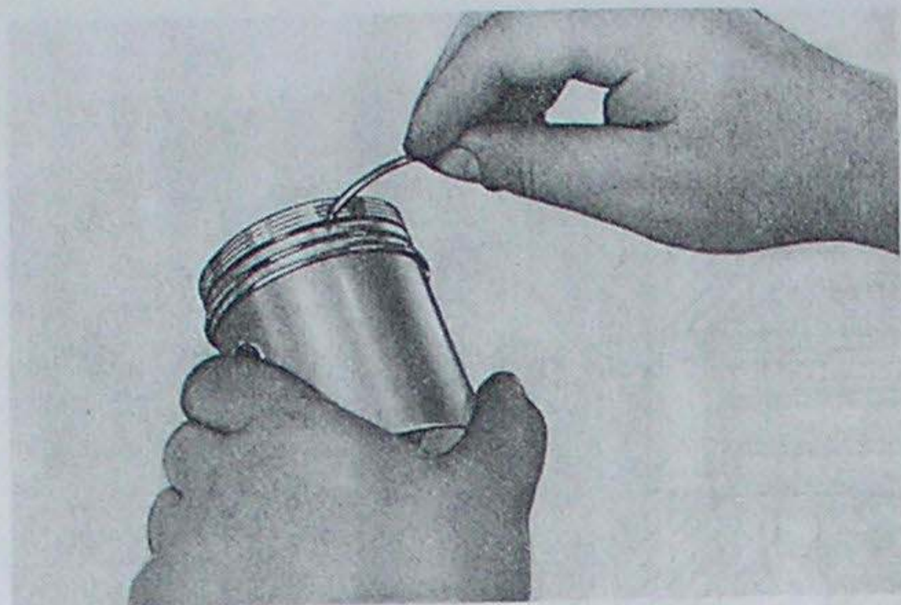
Obr. 238. Čištění drážek kroužků
