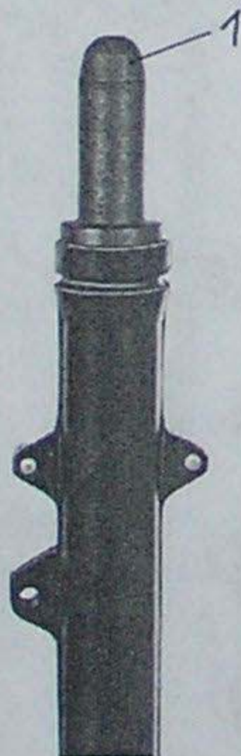
Obr. 29. Zatlačení hřídelového těsnicího kroužku
