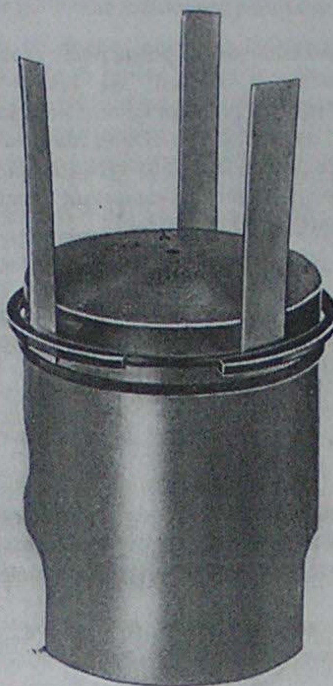
Obr. 159. Sejmutí pístních kroužků
