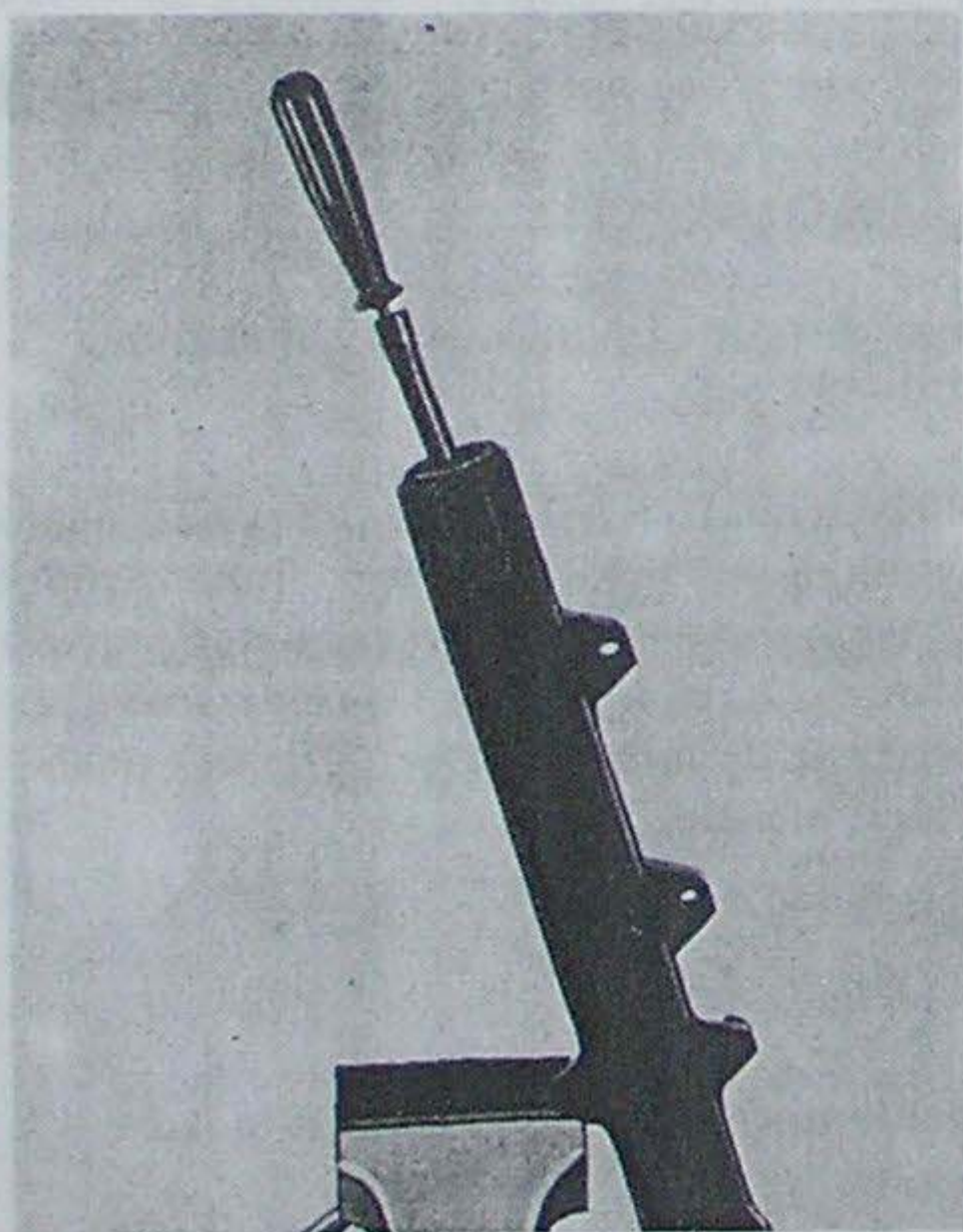
Obr. 24. Vyjmutí matice opěrné trubky
