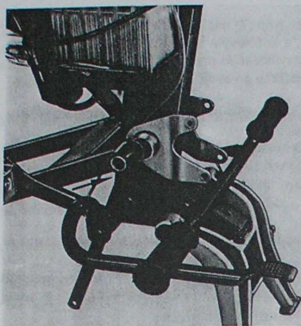
Obr. 16. Nasunutí kyvné vidlice zadního kola ve směru šipky, tlačné kroužky jsou již odstraněny
