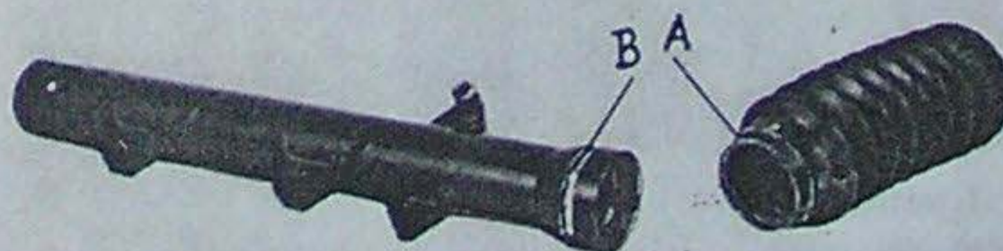
Obr. 31. Správné usazení ochranného měchu nebo ochranné čepičky
